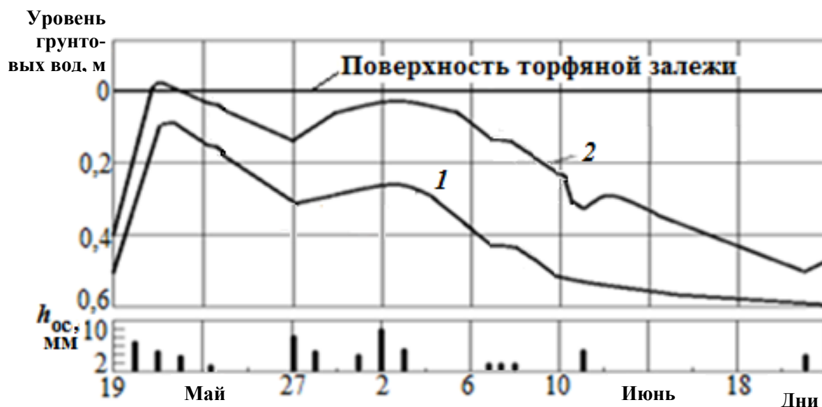
Рис. 1. Колебания уровня грунтовых вод на площадках с расстоянием между картовыми каналами: 1 – 10 м; 2 – 20 м
