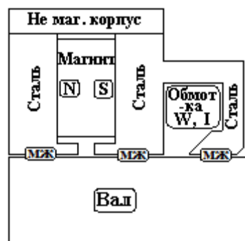
Рис. 7. Конструкция опытного управляемого МЖГ
