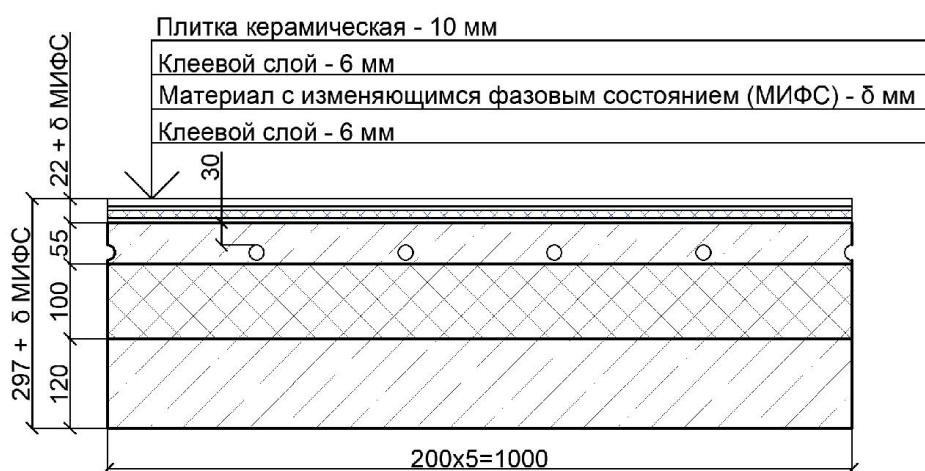
Рис. 1. Схема перекрытия с размещением МИФС над стяжкой (составлена авторами)
