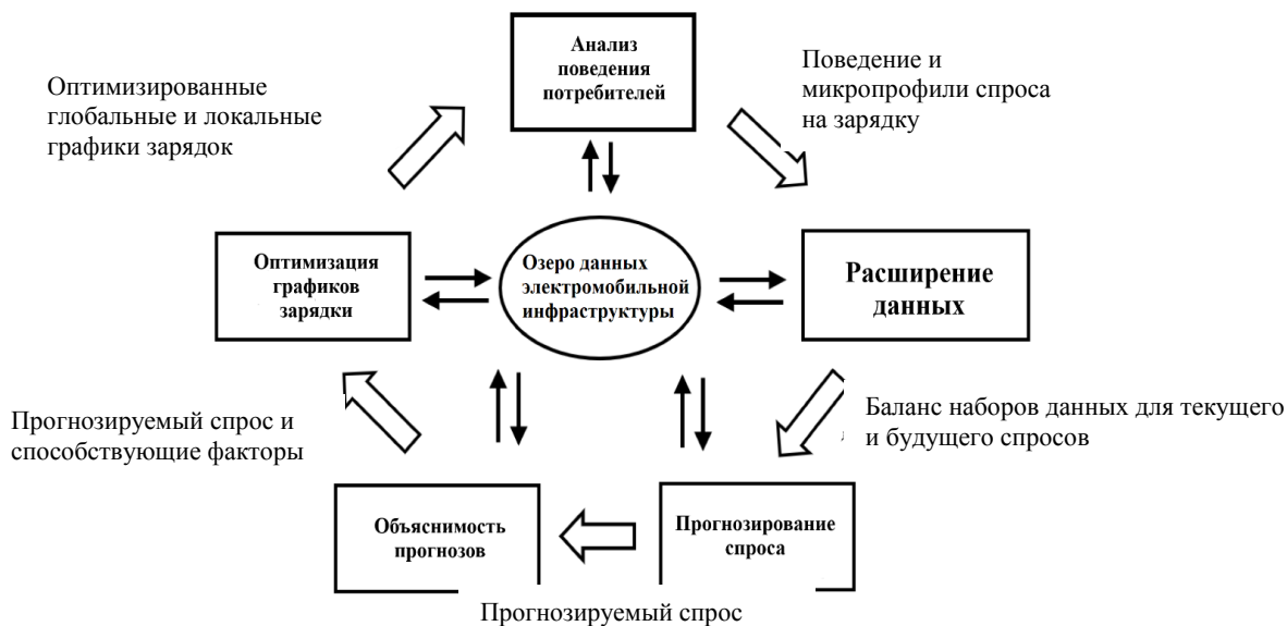
Рис. 2. Предлагаемая структура ИИ для инфраструктуры электромобилей
