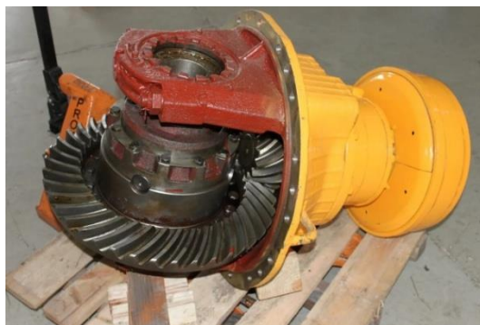
Рис. 1. Главная передача заднего моста самосвала БелАЗ
