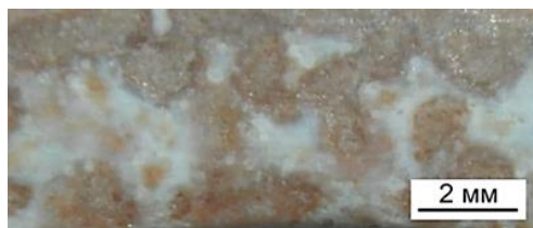
Рис. 6. Образец с локальными повреждениями на стадии дугового разряда
