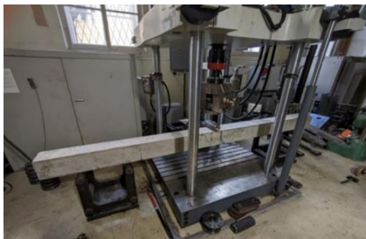
Рис. 2. Стенд для испытаний свай на трехточечный изгиб
