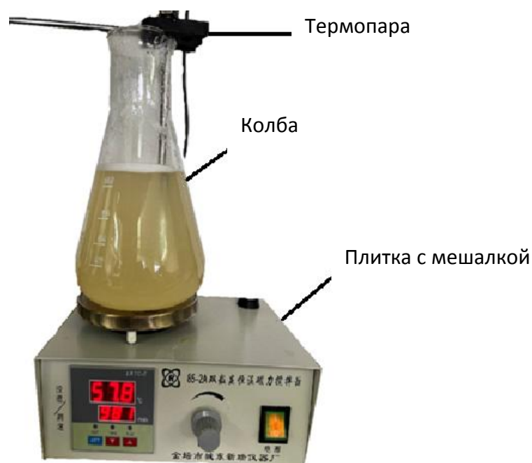
Рис. 2. Установка для проведения синтеза метионата кальция
