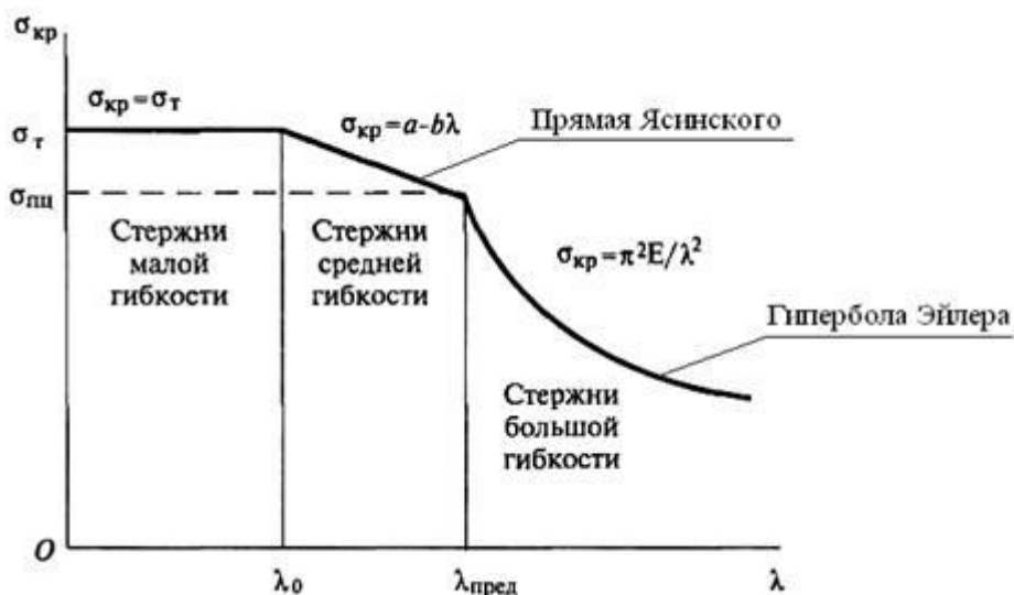
Рис. 2. График зависимости \sigma_{кр} от \lambda для стержней из пластичного материала [2]
