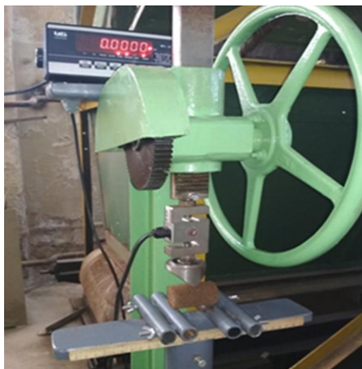
Рис. 2. Определение прочности образцов кускового торфа цилиндрической формы на изгиб
