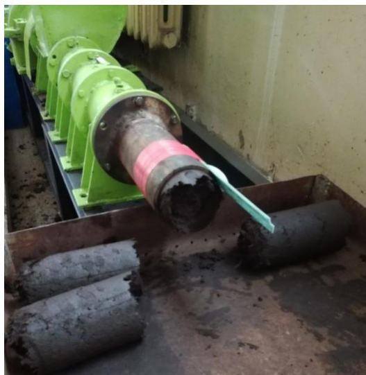
Рис. 1. Формование кускового торфа цилиндрического сечения на шнековом прессе
