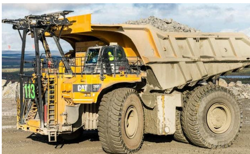
Рис. 4. Дизель-троллейвоз Caterpillar CAT 795F
