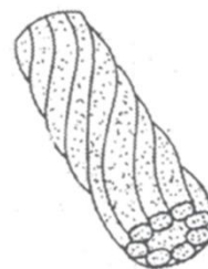
Рис. 3. Многоветьевая крученая гранула периодического профиля
