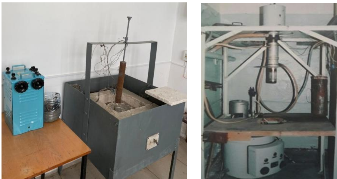
Рис. 1. Общий вид установки для определения теплопроводности бетона (слева) и установки для определения КЛТР жаростойкого керамзитобетона (справа) [8]
