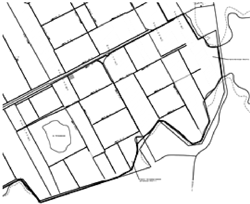
Рис. 3. Пример схемы осушительной сети первоочередного участка
