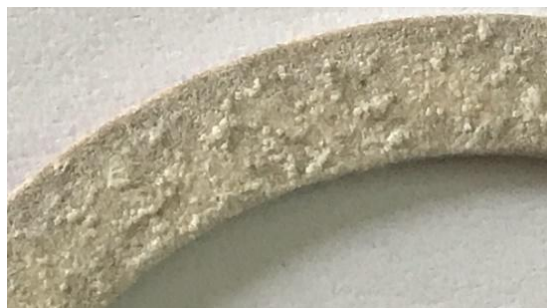
Рис. 1. Внешний вид технологического слоя на детали из сплава АМ5 после МДО
