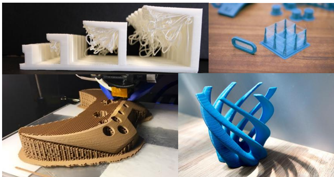
Рис. 2. Сложные конструктивные элементы, вызывающие проблемы при 3D-печати
