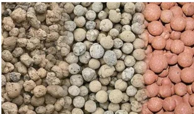
Рис. 1. Гранулы керамзитового гравия
