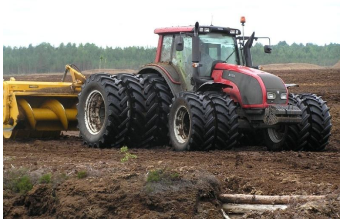
Рис. 1. Трактор на сдвоенных передних и строенных задних колесах в агрегате с шнековым профилировщиком поверхности картовых полей
