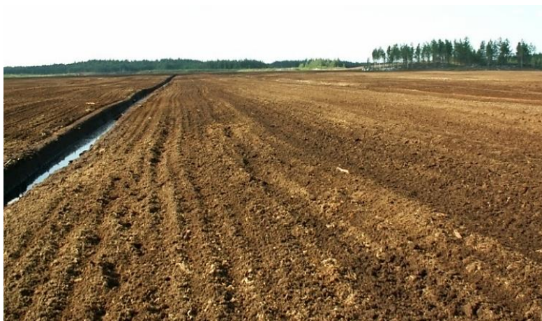
Рис. 4. Расстил торфяной крошки после ворошения
