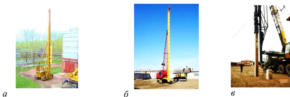
Рис. 5.2. Копровые установки: a – на тракторе; б – на экскаваторе; в – на автомобиле
