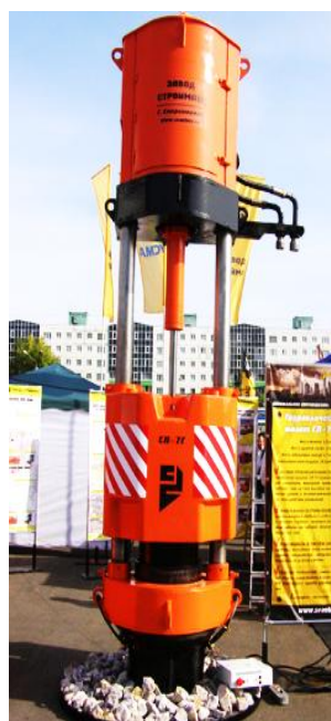
Рис. 5.7. Молот гидравлический: а – общий вид; б – конструктивная схема
