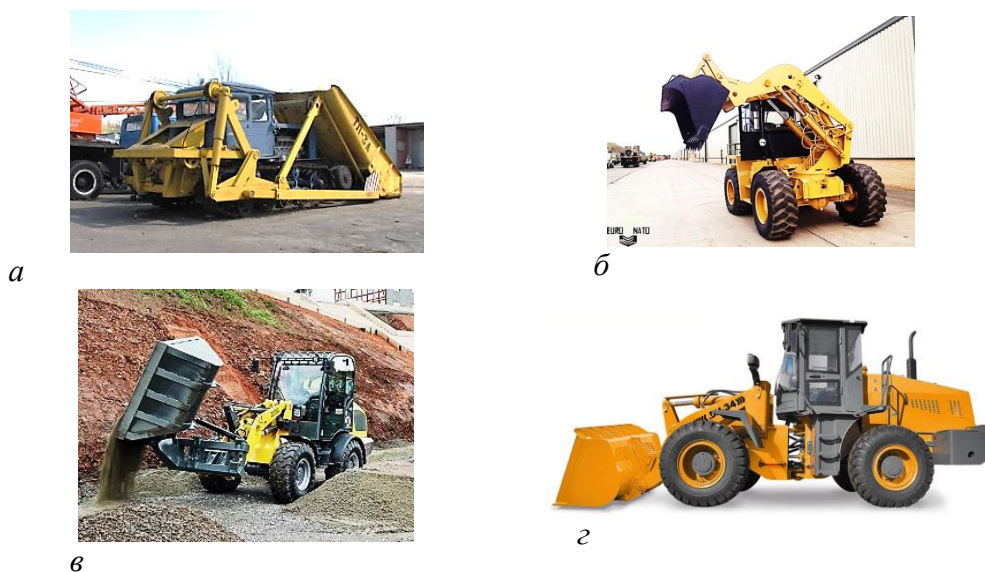
Рис. 2.1. Фронтальные погрузчики периодического действия: а – с задней разгрузкой; б – полуповоротный; в – с ковшем боковой разгрузки; г – шарнирно-сочлененной рамой
