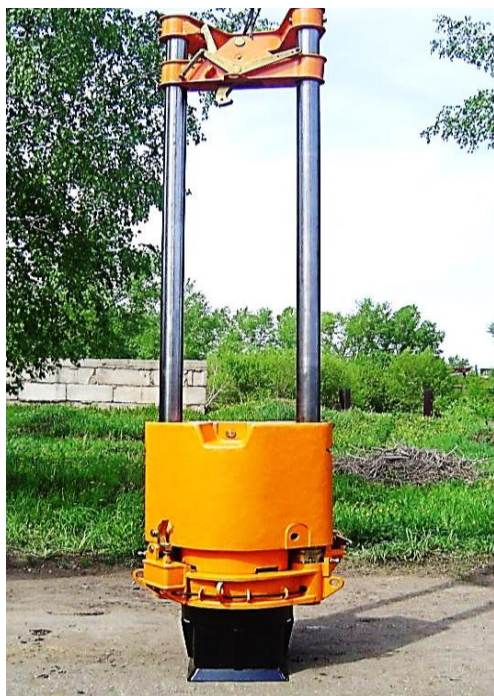
Рис. 5.6. Дизель-молоты: а – штанговый; б – трубчатый
