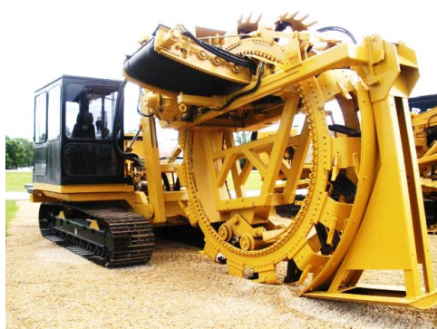
Рис. 4.6. Траншейные экскаваторы: а – цепной многоковшовый; б – цепной с резцами; в – роторный ковшовый; г – роторный фрезерный
