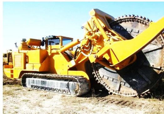
Рис. 4.6. Траншейные экскаваторы: а – цепной многоковшовый; б – цепной с резцами; в – роторный ковшовый; г – роторный фрезерный
