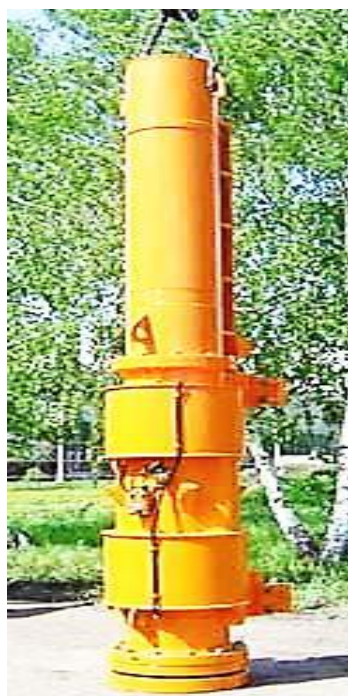
Рис. 5.6. Дизель-молоты: а – штанговый; б – трубчатый
