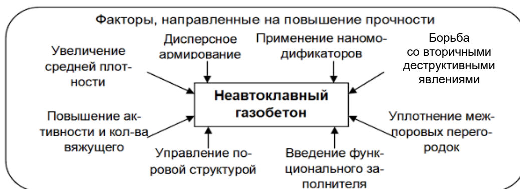
Рис. 1. Основные пути повышения прочности газобетона [6]
