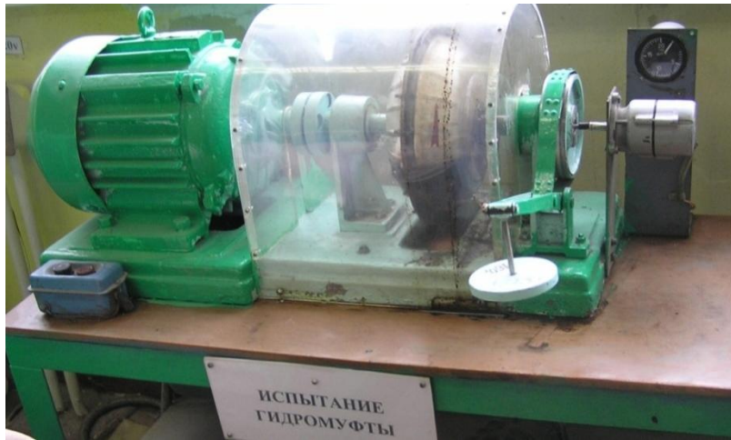
Рис. 2.23. Общий вид лабораторной установки для испытания гидромукты Схема ленточного тормоза, необходимая для расчета тормозного момента M_T , представлена на рис. 2.24.
