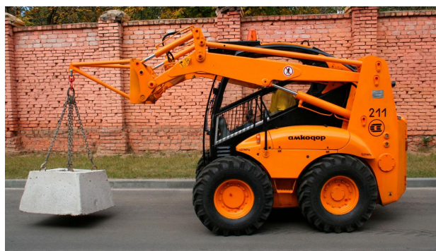
Рис. 4. Заводские испытания фронтального мини-погрузчика «АМКОДОР 211» на продольную устойчивость
