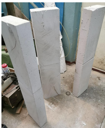
Рис. 1. Твердение образцов клееных газобетонных перемычек
