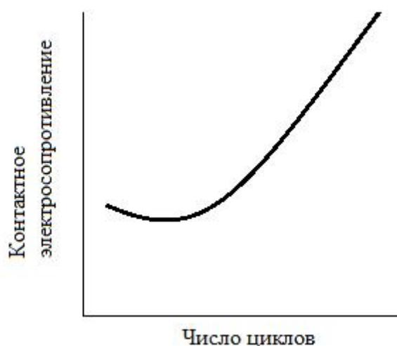
Рис. 7.8. Характер зависимости контактного электросопротивления от числа циклов тангенциального смещения (логарифмический масштаб)
