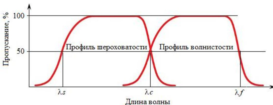
Рис. 3.2. Фильтрация профиля рельефа поверхности
