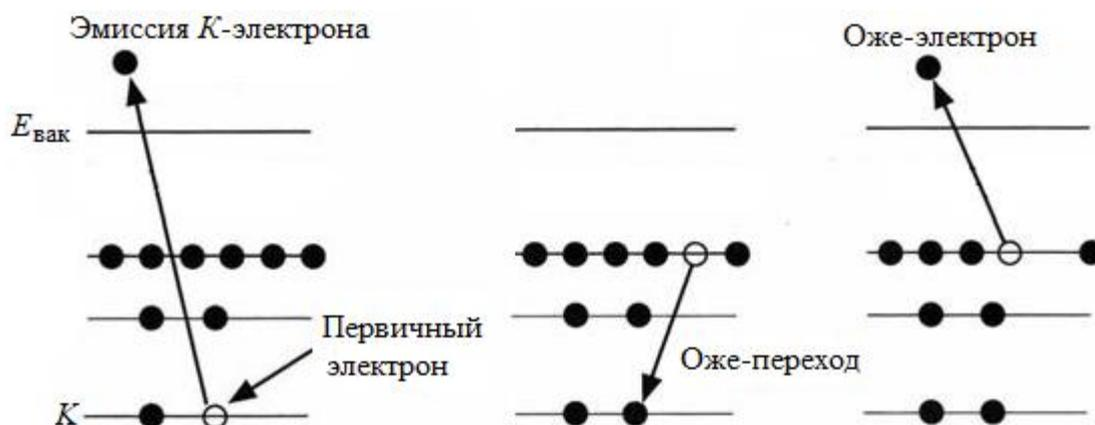
Рис. 2.15. Схема электронных переходов при оже-эффекте [24]:
