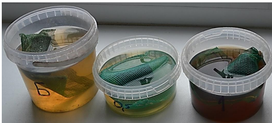
Рис. 5. Эксперимент по определению величины водопоглощения кускового торфа
