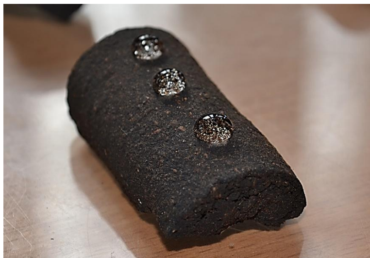
Рис. 6. Эксперимент по исследованию водоотталкивающих свойств кускового торфа
