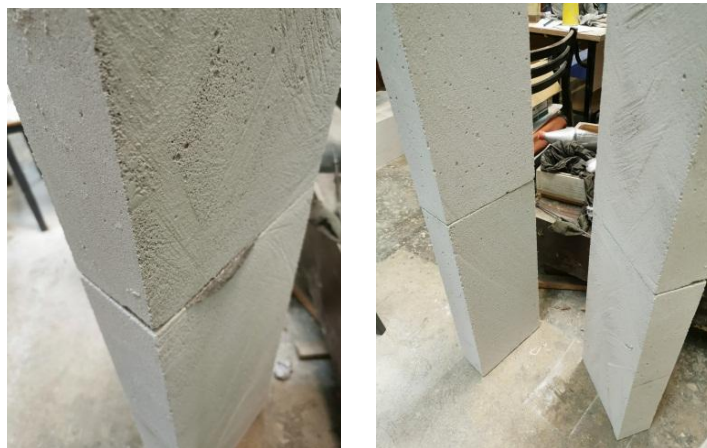
Рис. 2. Процесс корректировки положения заготовок и твердения перемычек
