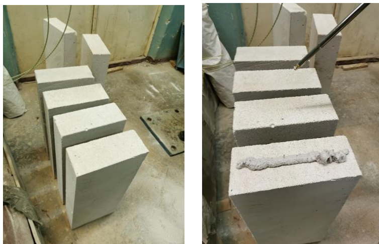
Рис. 1. Процесс нанесения клей-пены на газобетонные заготовки
