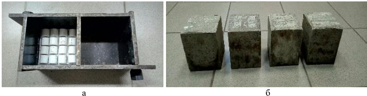
Рис. 4. Модельные образцы – кубики, матрица которых равномерно заполнена дискретными пластиковыми трубками: а – на этапе формования; б – готовые образцы
