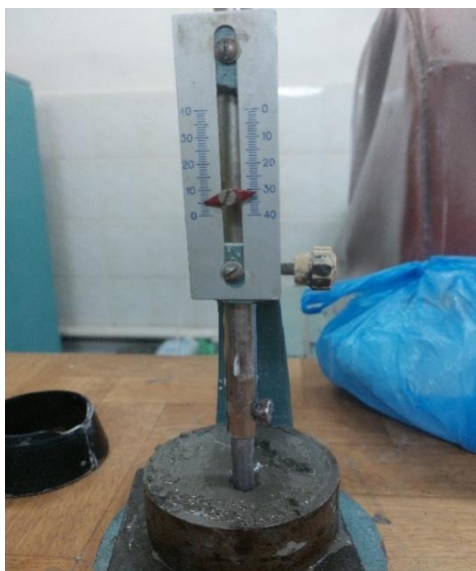
Рис. 3. Определение нормальной густоты цементного теста
