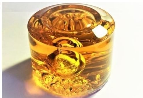
Рис. 2. Образец полимеризованного нерасширяющегося двухкомпонентного инъекционного полиуретанового состава
