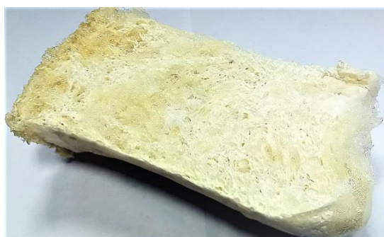
Рис. 1. Образец полимеризованного гидроактивного полиуретанового состава с закрытопористой структурой
