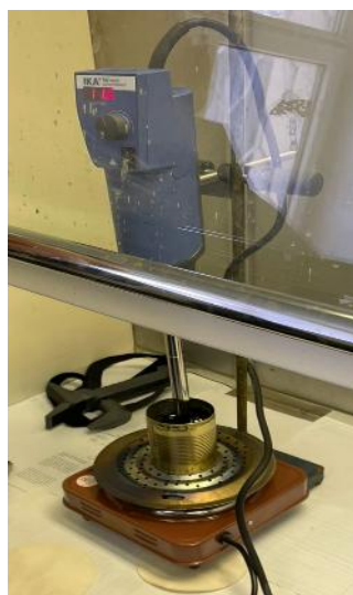
Рис.2. Распределение компонентов в битумной смеси с помощью смесителя ИКА Ultra-Turrah T25 digital
