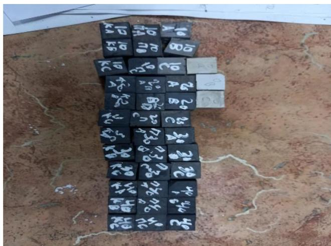
Рис. 2. Образцы гипсового композита до испытаний
