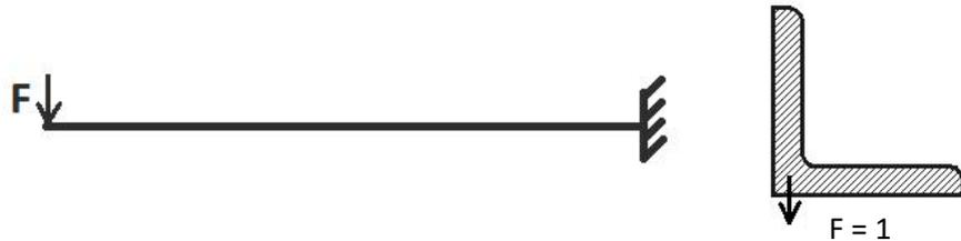
Рис. 1. Схема загрузки уголка
