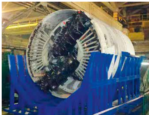
Рис. 2. Опытный образец ПА модели 401 диаметром 3,2 м
