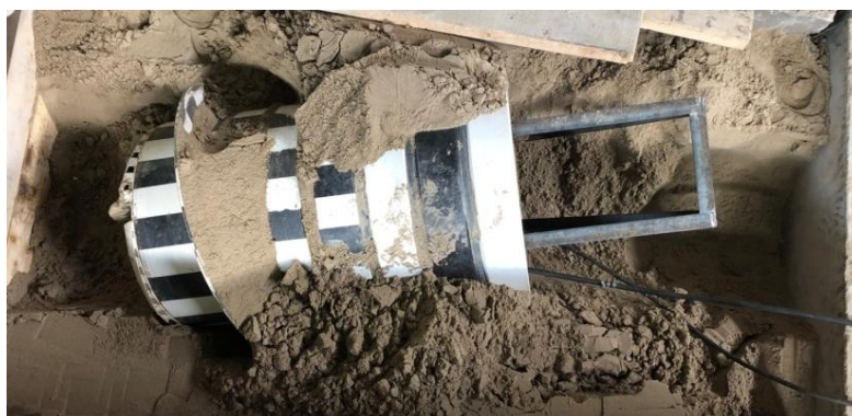
Рис. 5. Положение демонстрационного образца геохода после предварительных испытаний
