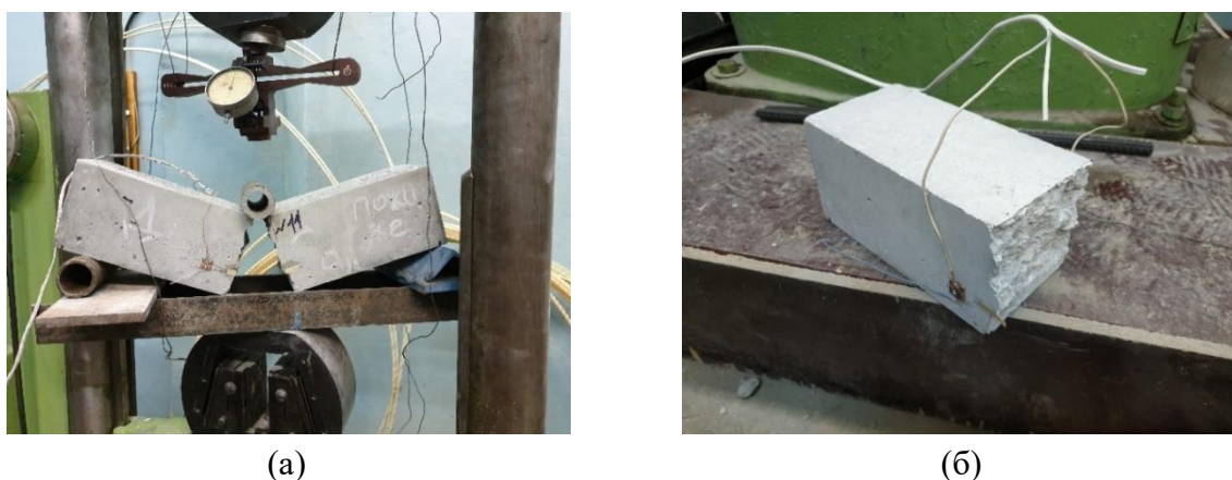
Рис. 4. Процесс разрушения контрольного образца карбонатного бетона (а) и одна из его половин с шероховатой развитой поверхностью после разрушения (б)
