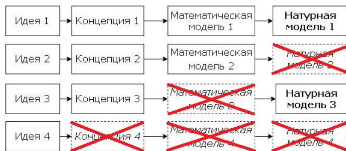
Рис. 2. Расширенный вариант структуры взаимодействия идеи и натурной модели, которая является тестовым макетом системы
