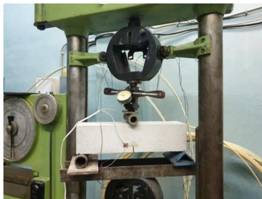
Рис. 1. Испытательное устройство с образцом и электрическим измерителем для определения мгновенных и длительных напряжений
