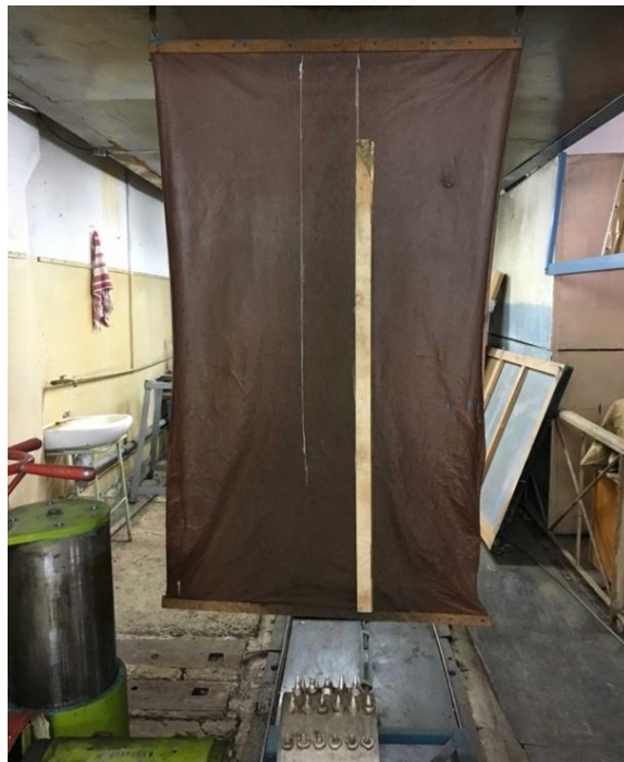
Рис. 5. Экран для фиксации траектории полета фрезерной крошки
