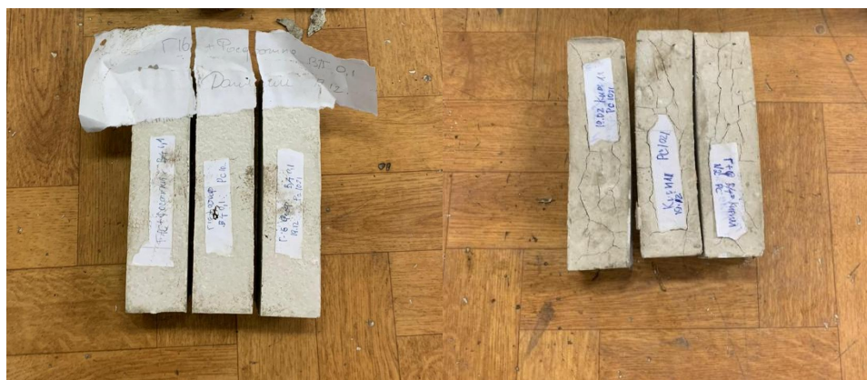
Рис. 3. Образцы-балочки на основе фосфогипсовых смесей
