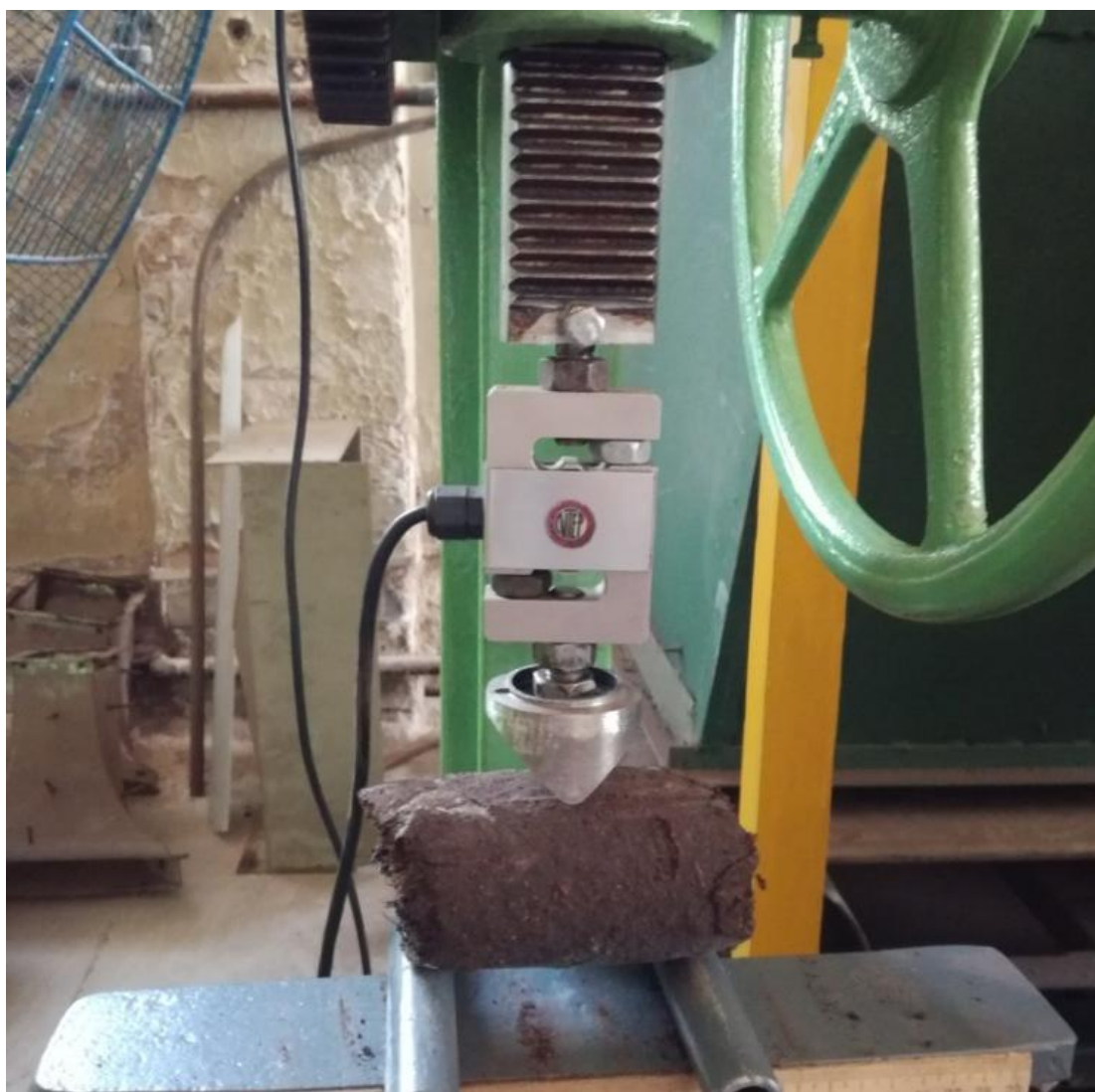
Рис. 3.22. Установка в тело тензоскобы дополнительных металлических проставок, изготовленных из гаек М14
