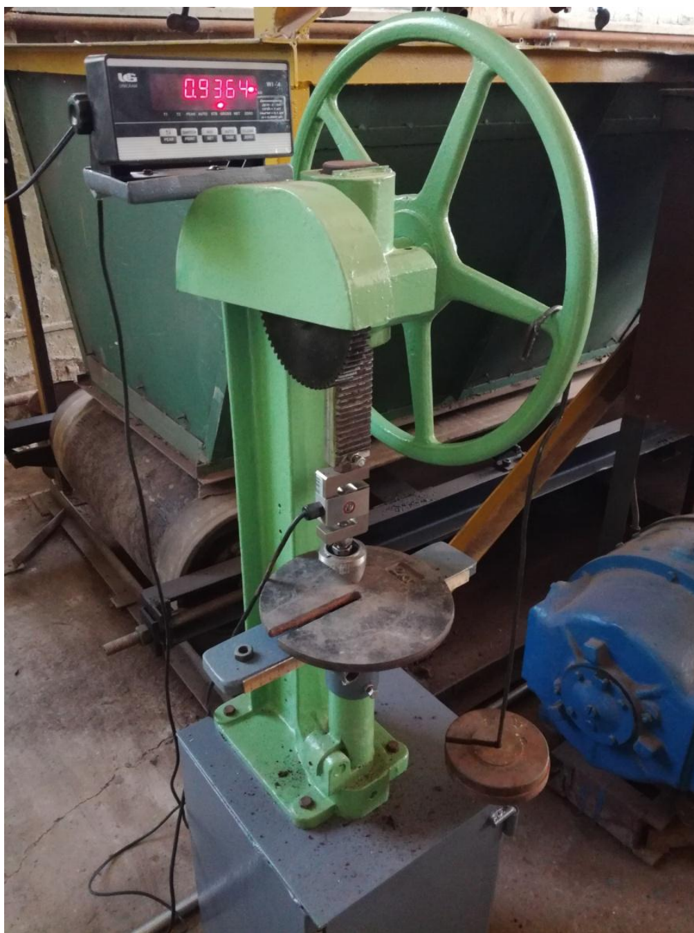
Рис. 3.23. Процесс тарировки тензоскобы методом навешивания калиброванных грузов на штурвал стенда
