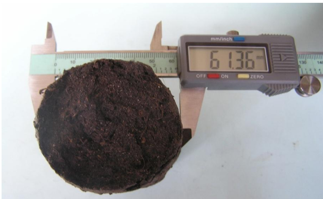
Рис. 3.14. Измерение образцов кускового торфа цифровым штангенциркулем ШЦЦ 1-150-0,01
