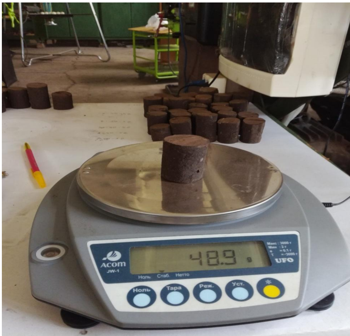
Рис. 3.15. Взвешивание образцов кускового торфа на весах АСОМ JW-1
