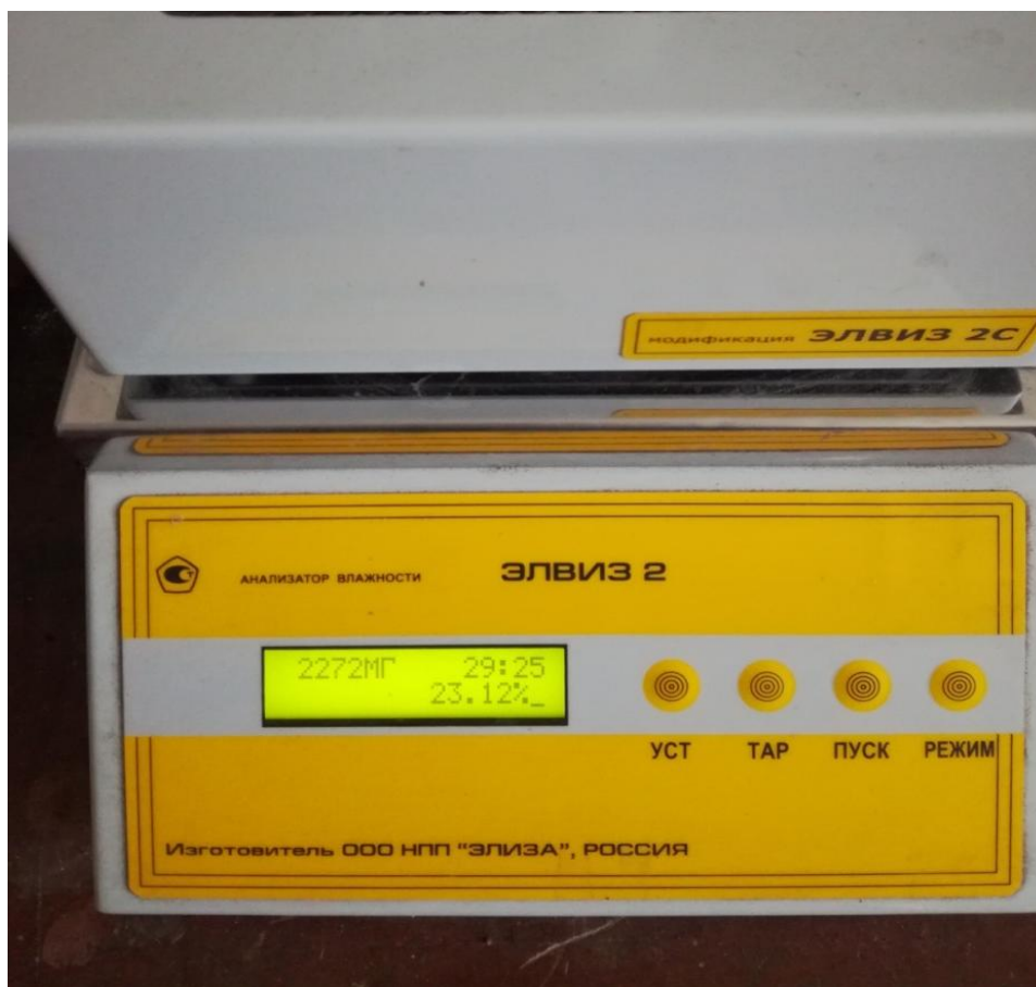
Рис. 3.13. Контроль среднего содержания влаги высушенного кускового торфа
