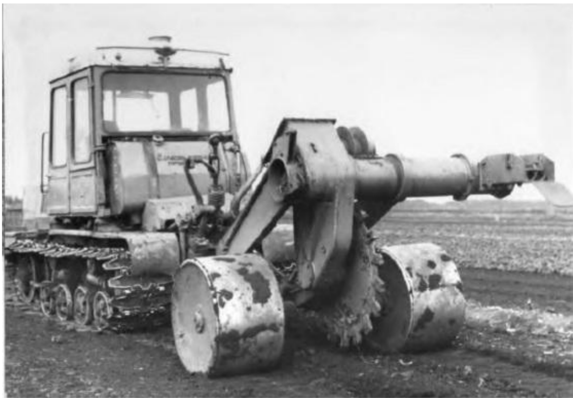
Рис. 1.15. Фрезформовочная машина МТК-16 в транспортном положении
