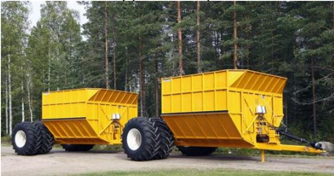
Рис. 4.4. Двухосный приводной прицеп JPV-45 для внутримассивных перевозок
