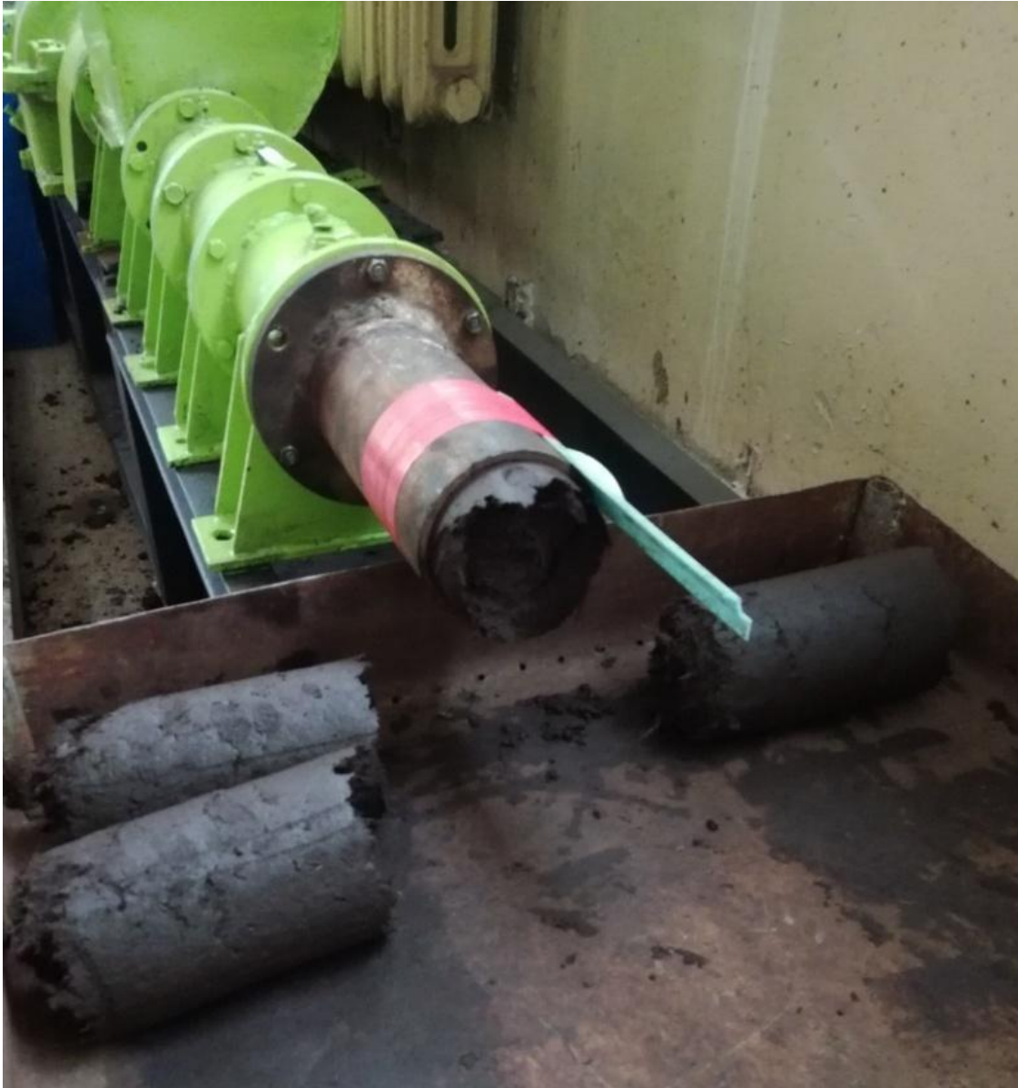
Рис. 3.6. Процесс формования торфа
