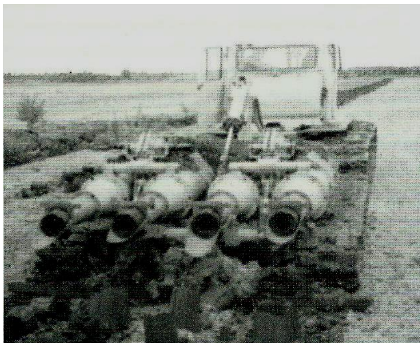
Рис. 1.24. Машина КМК-1 для добычи, формирования и выстилки кускового торфа
