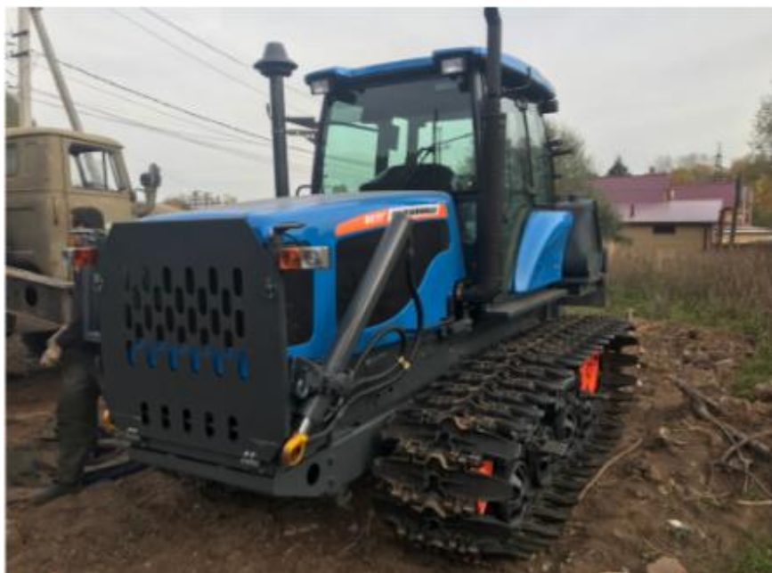
Рис. 4.13. Гусеничный болотоходный трактор Агромаш-90ТГ
