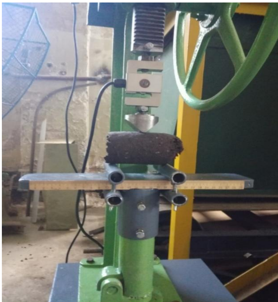
Рис. 3.21. Испытание на изгибную прочность образцов кускового торфа круглого сечения
