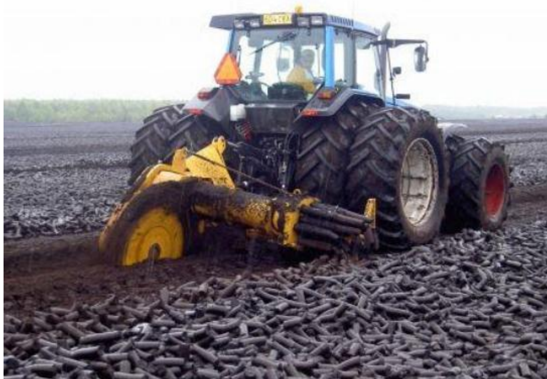
Рис. 1.22. Машина для добычи кускового торфа РК-1 (РК-1S) финской компании Suokone Oy
