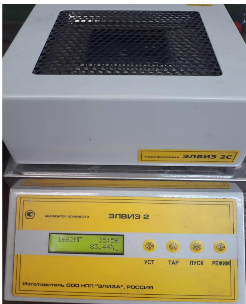
Рис. 3.1. Определение влаги исходного сырья прибором ЭЛВИЗ 2С
