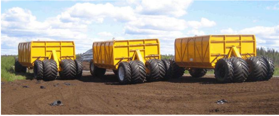
Рис. 4.4. Двухосный приводной прицеп JPV-45 для внутримассивных перевозок
