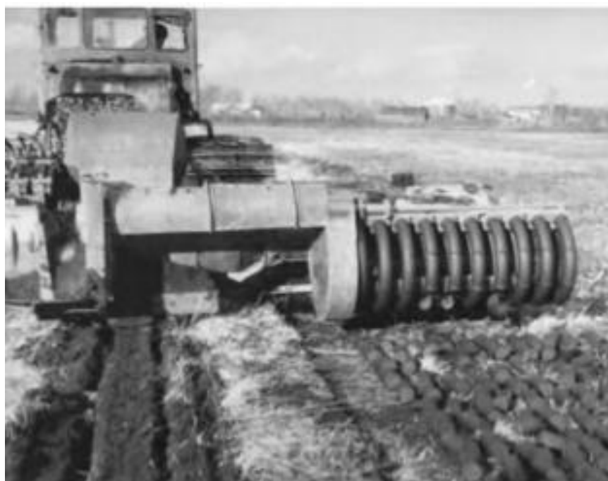
Рис. 1.25. Фрезформовочная машина МБТ-600 с торовым формователем
