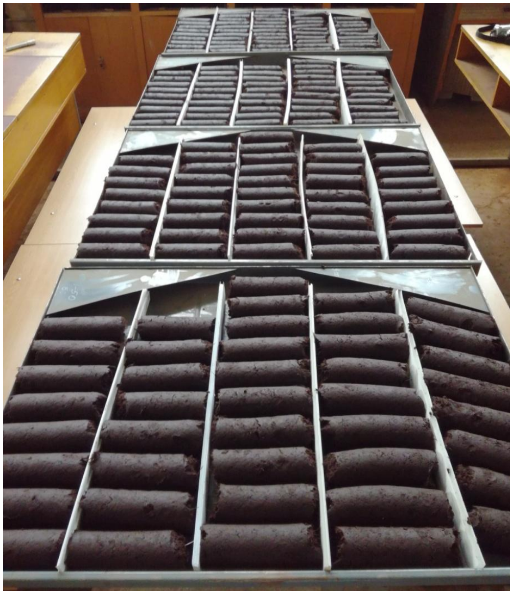
Рис. 3.7. Сушка кускового торфа в мягком режиме до достижения среднего равновесного содержания влаги
