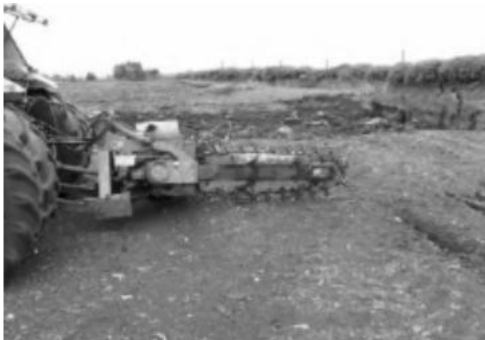
Рис. 1.23. Фрезформовочная машина HERBST для добычи кускового торфа (компания DIFCO, Ирландия)
