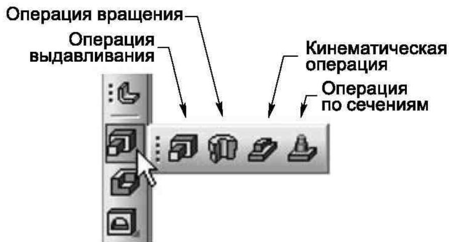
**Рис. 4а.** Расширенная панель команд формообразующих операций (добавления элементов)
