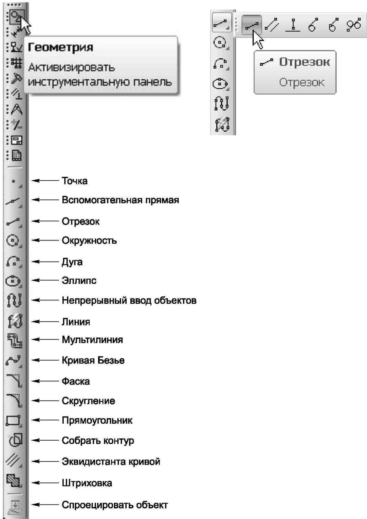
Рис. 2.а. Инструментальная панель *Геометрия*
