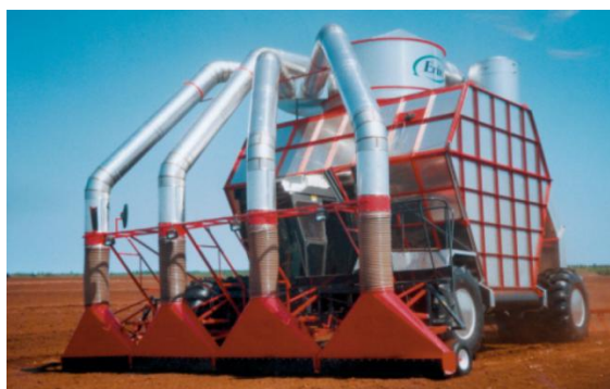
Рис. 2. Самоходный пневмоуборочный комбайн фирмы Premier Tech Ltd SAM-400
