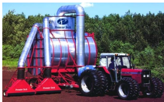
Рис. 3. Прицепная пневмоуборочная машина фирмы Premier Tech Ltd SA-200
