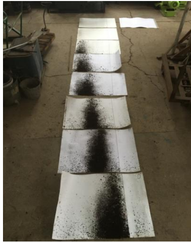
Рис. 2. Траектории полета торфяной крошки
