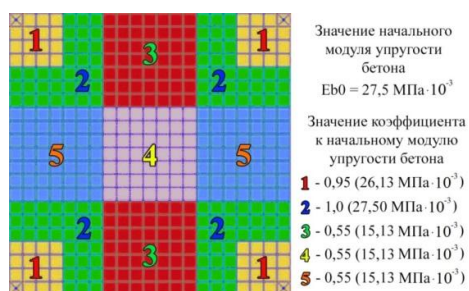
Рис. 2. Зоны уточнения модуля упругости бетона для первой группы предельных состояний
