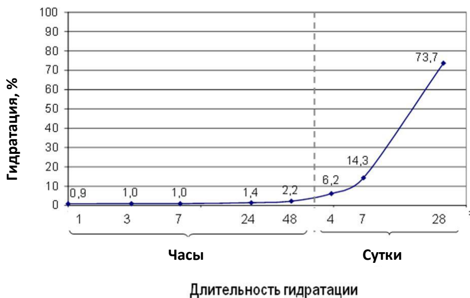
Рис. 4. Процесс гидратации высокообожженного гипсового камня после его помола с фазовым составом: нерастворимый ангидрит (48 ч) – 97.5... 98.7 %, трудно растворимый ангидрит – 0.4... 1.5 %
