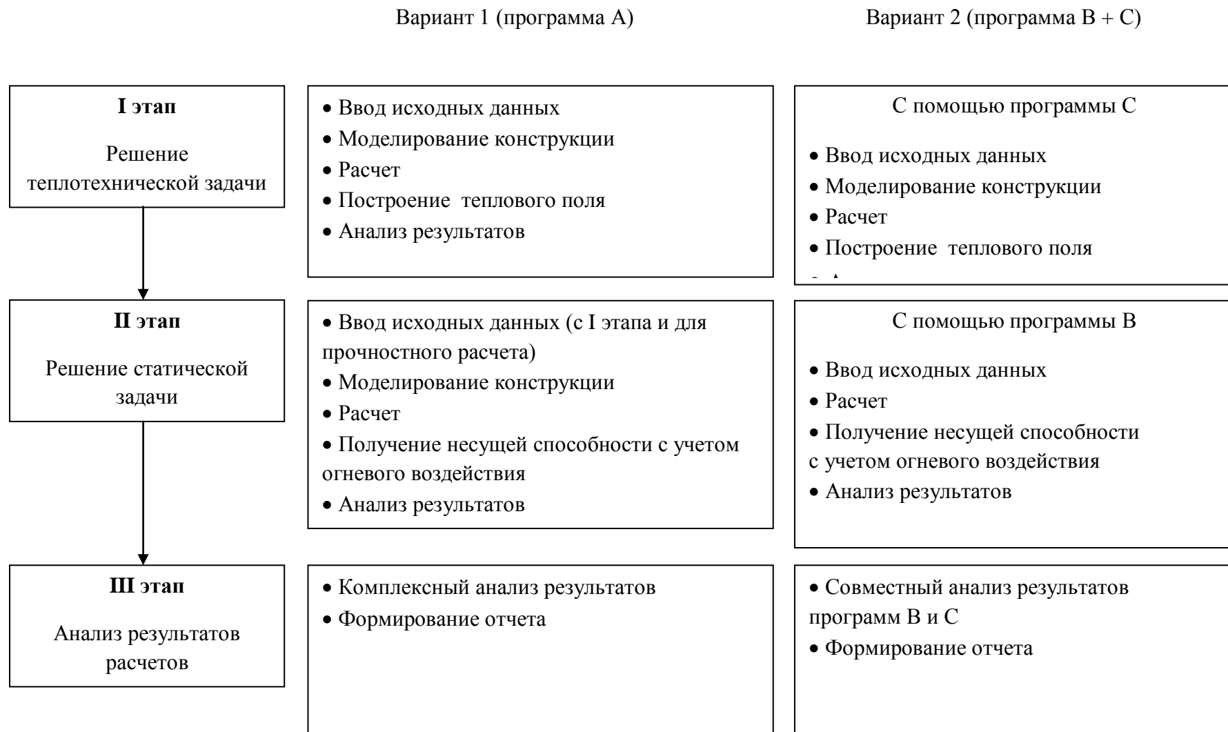
Диаграмма укрупненного алгоритма решения задачи огнестойкости строительных конструкций
