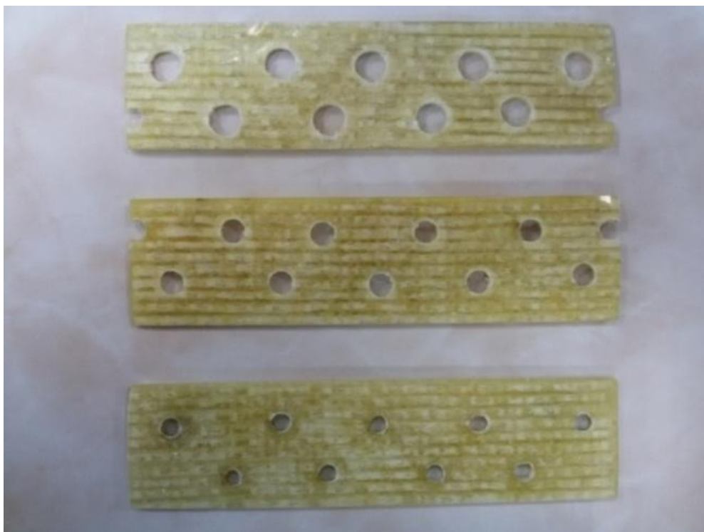
Рис. 5. Композитные образцы – пластины с различной площадью анкерных отверстий
