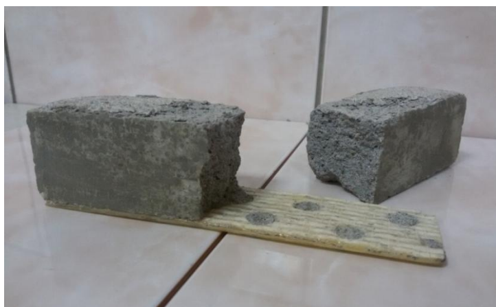
Рис. 7. Вид комбинированной балочки после разрушения
