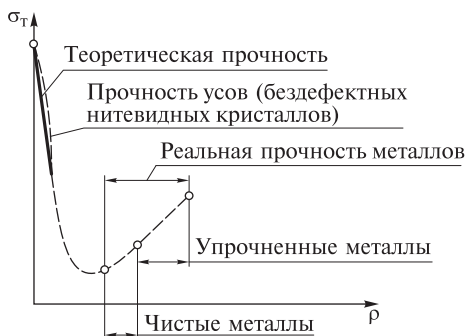
Рис. 1.4. Зависимость предела текучести \sigma_T от плотности \rho дислокаций
